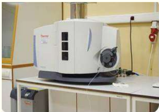
Опτικο-эмиссионный спектрометр с индуктивно связанной плазмой iCAP6300 Duo
