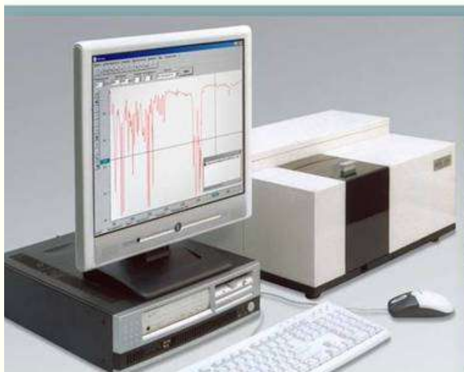
Опτικο-эмиссионный спектрометр с индуктивно связанной плазмой iCAP6300 Duo
